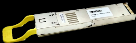
ELS integrating InP CW lasers, lenses, isolators, TECs, fiber assembly
